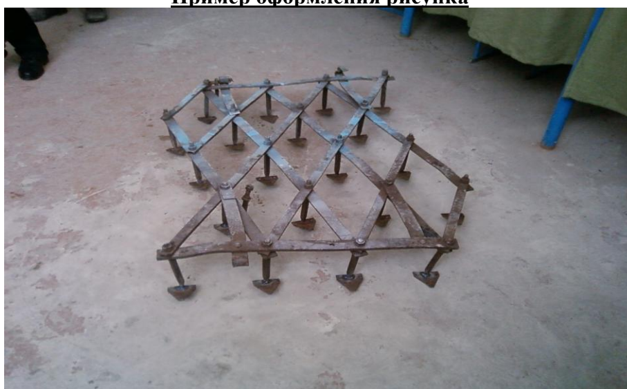
Рис.2 Переоборудованный бороновальный агрегат для поверхностной обработки почвы
